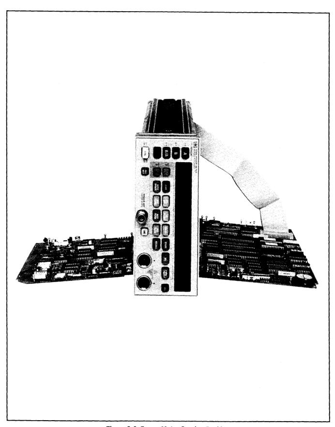
Figure 8-6. Power Meter Service Position
